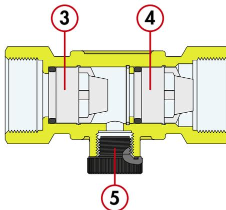
La valvola a doppio ritegno può essere utilizzata, nei casi consentiti dalla vigente normativa locale, in alternativa al disconnettore idraulico qualora si disponga di una ridotta pressione di ingresso dalla rete di distribuzione idrica. La tenuta del ritegno, inoltre, può essere controllata mediante la presa di pressione ricavata sul corpo valvola.
