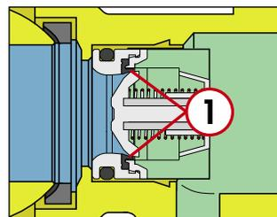
In caso di forte contropressione l'otturatore (2) deforma la guarnizione (1) e si appoggia sulla battuta. Questa soluzione garantisce una lunga durata del dispositivo.
