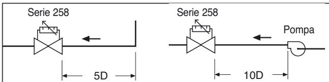
La valvola può essere installata in qualsiasi posizione rispettando il senso di flusso evidenziato sul corpo valvola. Essa può essere montata indifferentemente su tubi orizzontali o verticali.
