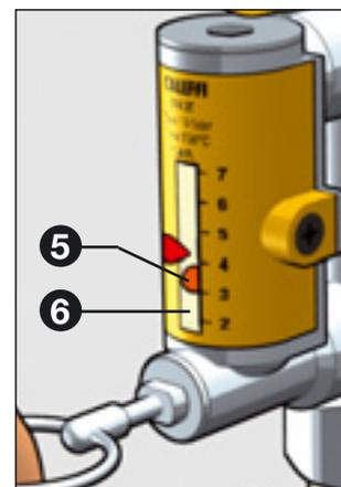
D. Conclusa l'operazione di bilanciamento, rilasciare l'anello dell'otturatore del flussometro che, grazie ad una molla interna, si riporterà automaticamente in posizione di chiusura.
