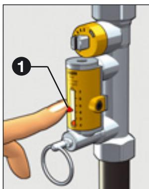
B. Aprire, mediante l'anello (2), l'otturatore che intercetta il passaggio del fluido nel flussometro (3) in condizioni di normale funzionamento.
