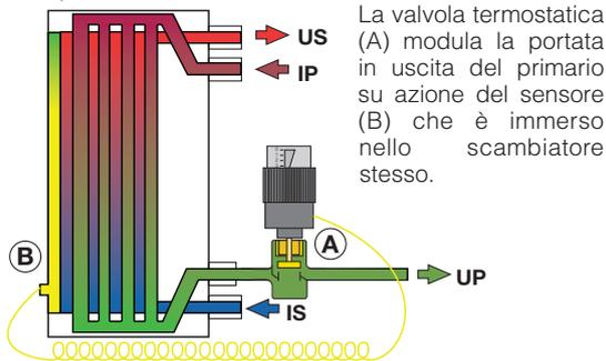
La valvola termostatica (A) modula la portata in uscita del primario su azione del sensore (B) che è immerso nello scambiatore stesso.
