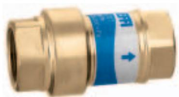
La mandata principale del fluido termovettore è dotata di stabilizzatore automatico compatto di portata AUTOFLOW® (1) (range di portata disponibili 600÷1200 l/h). In mancanza di specifiche verrà installata la cartuccia M90 con portata 900 l/h.
