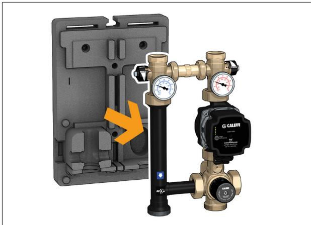
2. Svitare completamente le calotte mobili (tramite delle idonee chiavi) poste sotto le valvole di intercettazione di mandata e ritorno. Svitare anche le calotte mobili presenti sulla valvola miscelatrice, rimuovere la valvola e la pompa.
