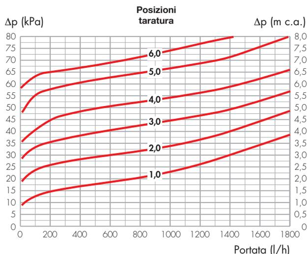
Le caratteristiche idrauliche sono ottenute tenendo conto della presenza delle valvole di intercettazione a sfera.
