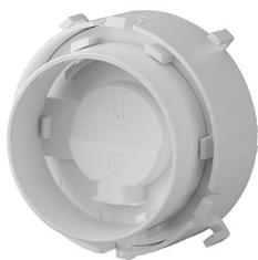
L'adattatore viene utilizzato quando si vuole posizionare la sezione elettronica del contatore di calore distanziata rispetto alla parte idraulica: l'impiego è consigliato soprattutto nel condizionamento o per agevolare le letture dei consumi termici quando si hanno installazioni idrauliche disagiate. La distanza massima tra sezione idraulica ed elettronica è pari a 35 cm circa ed è definita dal cavo di collegamento a disposizione.
