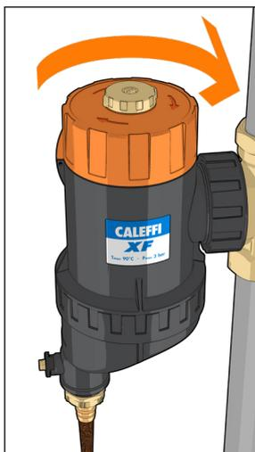
4. Al termine della pulizia, allineare l'indicatore della manopola superiore con il riferimento presente sul corpo del dispositivo. Richiudere il rubinetto di scarico ed avviare l'impianto.
