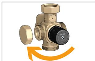
4. Posizionare il tubo di collegamento a destra, ruotandolo di 180° rispetto al suo asse.
