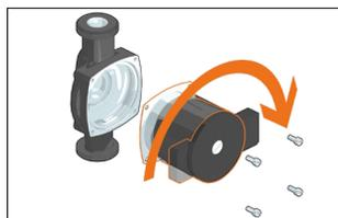
Nelle versioni con pompa UPML 25-105 ruotare la parte elettronica della pompa, svitando le quattro viti indicate dalle frecce e ruotando il corpo di 90° in senso antiorario. Senza eseguire questa operazione, non è possibile reinserire il gruppo nella coibentazione.
