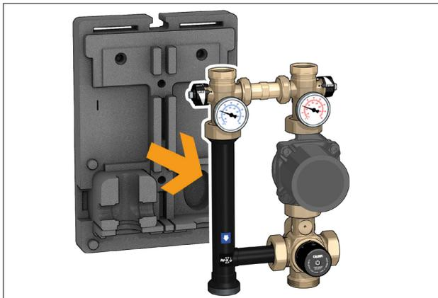
2. Svitare completamente le calotte mobili (tramite delle idonee chiavi) poste sotto le valvole di intercettazione di mandata e ritorno. Svitare anche le calotte mobili presenti sulla valvola miscelatrice, rimuovere la valvola e la pompa.
