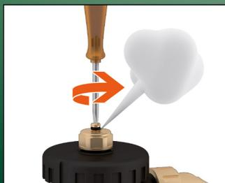
Svitando il tappo superiore con un apposito cacciavite o con una chiave a farfalla, è possibile evacuare l'aria che si accumula nella parte superiore del corpo.
