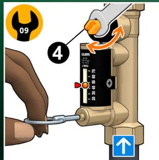
Mantenendo aperto l'otturatore, agire con una chiave di manovra sull'asta di comando della valvola (4) per effettuare la regolazione della portata. Essa viene indicata da una sfera metallica (5), che scorre all'interno di una guida trasparente (6) a lato della quale è riportata una scala graduata di lettura espressa in l/min.
