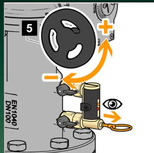
Continuando a tirare l'anello, agire sull'apposito volantino (5) per effettuare la regolazione della portata. Essa viene indicata da una sfera metallica (6), che scorre all'interno di una guida trasparente (7) a lato della quale è riportata una scala graduata di lettura espressa in m³/ora.
