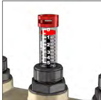
Agendo manualmente sulla base del flussometro, è possibile regolare la portata di ogni singolo circuito al valore richiesto con la possibilità di leggere il valore su ciascun flussometro.
