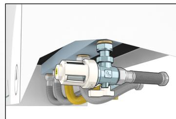
Corredato di codolo con calotta mobile per agevolare il montaggio sottocaldaia.
