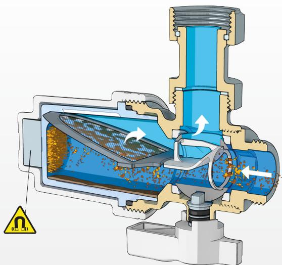
La camera è dotata di finestre trasparenti tramite cui è possibile verificare la necessità di pulizia degli elementi interni.
