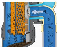
2. Nella zona centrale è presente una sonda magnetica che cattura la magnetite e le impurità ferrose fino alle dimensioni più piccole.
