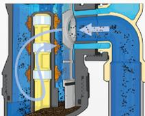
3. In uscita dalla camera di trattamento il fluido termovettore passa da un filtro, che blocca meccanicamente tutte le residue impurità contenute nel fluido.
