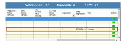
Come per le altre segnalazioni è necessario entrare nell'unità abitativa per verificare le condizioni del ripartitore; in questo caso però il dispositivo non è da sostituire: rimuovere il sigillo che è stato rotto con l'apertura, chiudere il ripartitore fissandolo al corpo scaldante e apporre il nuovo sigillo.
