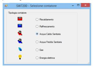
È possibile collegare all'acquisitore un solo contatore, che può essere di diverse tipologie: contatore di riscaldamento, di raffrescamento, contatore volumetrico acqua calda sanitaria, volumetrico acqua fredda sanitaria, contatore di gas o di energia elettrica.
