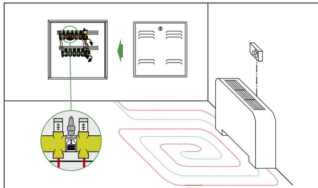
**ATTENZIONE:** mediante la sonda limite UR%, si anticipa l'eventuale formazione di condensa. Nei locali dove sia presente il raffrescamento, deve esserci sempre un adeguato trattamento dell'aria.
