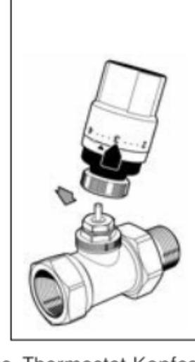
Per il montaggio del comando termostatico sulle valvole da 1" è necessario rimuovere l'adattatore (1) ed avvitare direttamente il comando sul corpo valvola.
