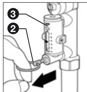
C. Mantenendo aperto l'otturatore, agire con una chiave di manovra (da 9 mm) sull'asta di comando della valvola (4) per effettuare la regolazione della portata. Essa viene indicata da una sfera metallica (5), che scorre all'interno di una guida trasparente (6) a lato della quale è riportata una scala graduata di lettura espressa in l/min.
