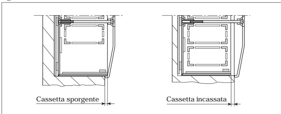
NOTA: la particolare conformazione del coperchio e la lunghezza delle viti di fissaggio permettono di compensare eventuali errori di posizionamento in profondità della cassetta ( Fig. A).
