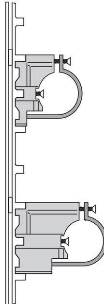
NOTA: i supporti lunghi verranno utilizzati per il fissaggio del collettore inferiore mentre i supporti corti verranno utilizzati per il fissaggio del collettore superiore.
