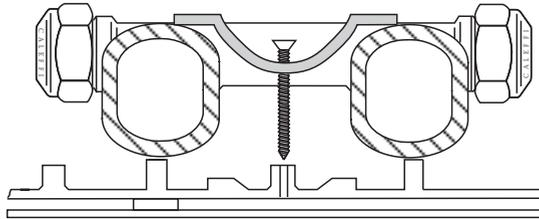
Per il fissaggio dei collettori semplici componibili serie 350 e 592 da 1" e per collettori serie 351 e 598 da 3/4" e 1" è necessario utilizzare i supporti cod. 360001 (Fig. C).
