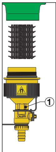
Per l'eventuale manutenzione del separatore multifunzione, è sufficiente svitare la camera accumulo fanghi, con una chiave esagonale da 26 mm (1), e sfilare l'elemento interno per effettuarne la pulizia.
