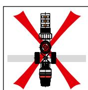
Vidanger le circuit sur lequel la soupape de sécurité thermique doit être installée et le nettoyer pour éliminer les impuretés qui pourraient s'y être accumulées durant l'installation. Il est possible d'installer la soupape en position verticale ou horizontale mais la section de vidange doit toujours être tournée vers le bas. Jamais tête en bas.
