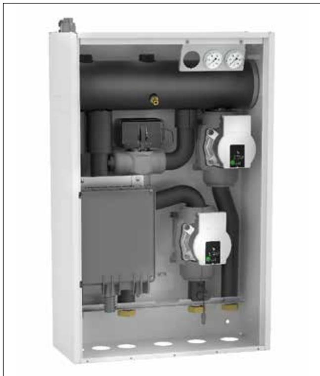
Il kit 2 zone per abbinamento a MAGIS COMBO 12-14-16 V2 e a MAGIS COMBO 12-14-16 PLUS V2 è composto dal telaio, dal collettore idraulico aperto, da elettropompe a basso consumo elettrico, valvola tre vie miscelatrice, tubi e raccordi idraulici e termometri per la lettura delle temperature.
