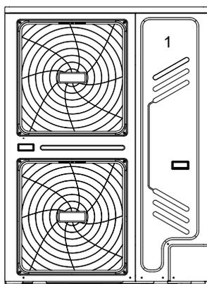
Rimuovendo il pannello anteriore (vedi fig. a lato), i componenti elettrici sono in vista sul davanti. I cavi d'alimentazione elettrica, possono essere inseriti nei fori predisposti. Bisogna fermare i cavi elettrici usando fascette di raggruppamento in modo che essi non possano toccare il compressore e le tubazioni calde.
