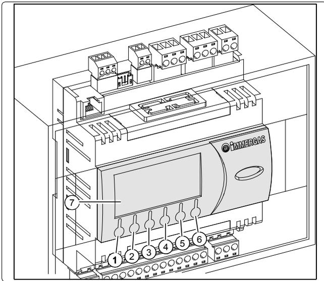
Il **pulsante (1)** permette di modificare la modalità di funzionamento del sistema e più precisamente: Estate (solo ACS e solare termico), Estate con raffrescamento, Inverno, Party (tutte le zone vengono portate in modalità comfort), Stand-by (disabilita tutte le richieste; rimane attiva soltanto la protezione anti-gelo ambiente < 5°C se presenti sonde ambiente Immergas).
