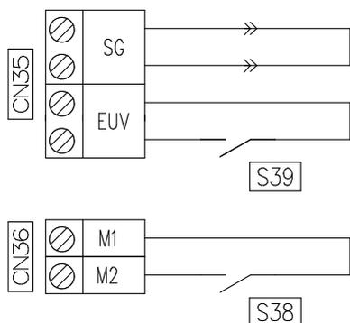
Per utilizzare il solo contatto fotovoltaico, applicare il ponte SG fornito di serie con la macchina, ma NON già installato.
