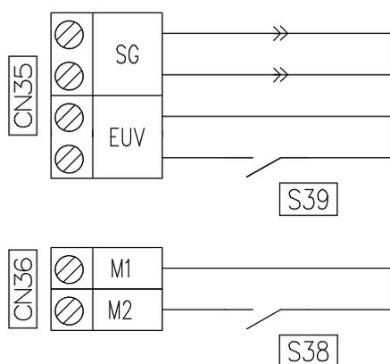
Per utilizzare il solo contatto fotovoltaico, applicare il ponte SG fornito di serie con la macchina, ma NON già installato.
