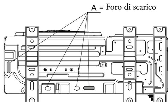
Questo foro di scarico è coperto da un tappo di gomma. Se il foro di scarico piccolo non può soddisfare i requisiti di scarico, si può utilizzare contemporaneamente il foro di scarico grande.
