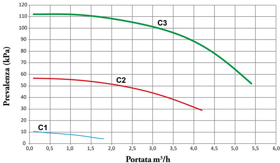
**C1:** Velocità I **C2:** Velocità II **C3:** Velocità III
