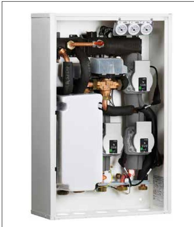
Due sistemi preconfezionati denominati: "Kit 2 zone miscelate" e "Kit 2 zone miscelate e 1 diretta", **per abbinamento a Pompe di calore fino a 8 kW di potenza**. Sono costituiti da 2 collettori idraulici separati (mandata/ritorno) + by-pass, termometri per la lettura delle temperature, valvole miscelatrici motorizzate, elettropompe a basso consumo elettrico e schede d'espansione per la gestione elettrica.
