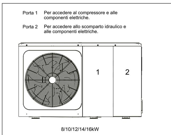
Rimuovendo il pannello anteriore (vedi fig. a lato riferito come ad esempio), i componenti elettrici sono in vista sul davanti. I cavi d'alimentazione elettrica, possono essere inseriti nei fori predisposti. Bisogna fermare i cavi elettrici usando fascette di raggruppamento in modo che essi non possano toccare il compressore e le tubazioni calde.
