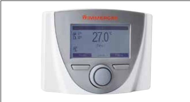
È un dispositivo elettronico dotato di display retroilluminato, per il controllo e la regolazione della temperatura e dell'umidità dell'ambiente. Il collegamento al Gestore di sistema avviene tramite due cavi BUS (gli stessi del collegamento MAGIS M). Permette la programmazione della termoregolazione dell'ambiente di pertinenza.
