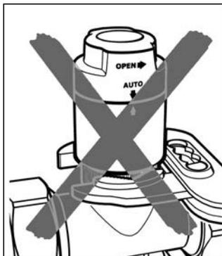
**ATTENZIONE:** Il comando elettrotermico va serrato a mano senza usare attrezzi.
