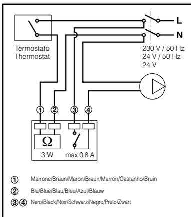
Il microinterruttore ausiliario si chiude per un valore medio di apertura del comando elettrotermico dell'80%.
