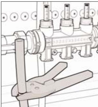
**8)** Ripetere l'operazione **2)**, quindi innestare a fondo l'adattatore ed inserire la clip di fissaggio nel suo alloggiamento.
