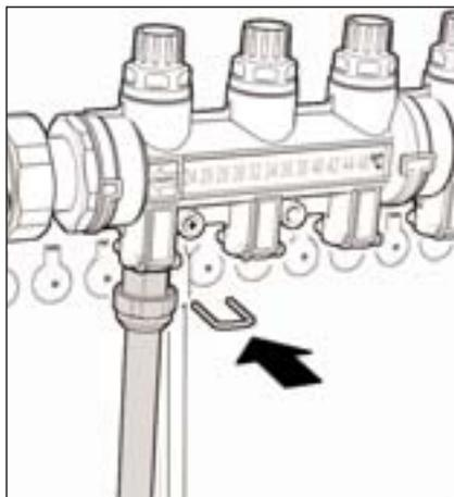
**Dopo la stesura del circuito pannelli**, tagliare la tubazione a misura per il collegamento alla derivazione del collettore di mandata, utilizzando l'apposita dima.
