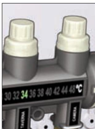
2) Sollevare il coperchio di blocco con l'aiuto di un cacciavite e rovesciarlo sul flussometro. Regolare la portata dei singoli pannelli ruotando il corpo flussometro che agisce sulla valvola di regolazione incorporata.
