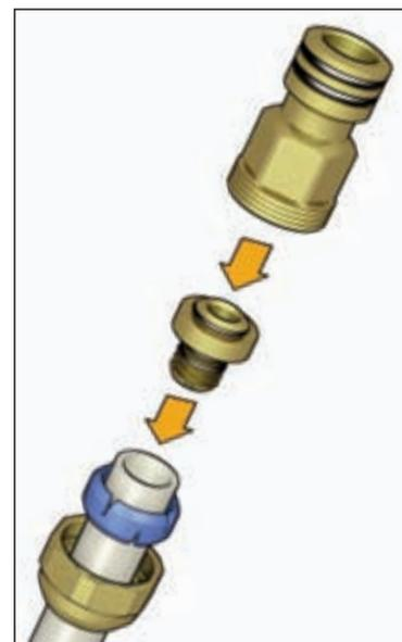
12) Serrare adattatore e raccordo mediante le apposite chiavi:
