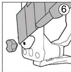
Le zanche sono predisposte anche per essere installate direttamente a muro. Gli spessori possono essere asportati tramite un taglierino, prima di procedere con l'installazione.
