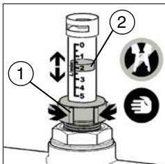
b) Ad impianto funzionante, regolare la portata di progetto agendo manualmente sulla ghiera di regolazione (1).
