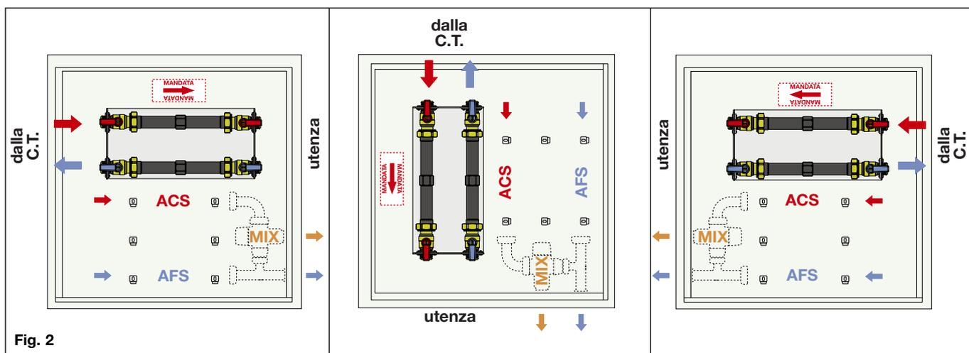
Nota: le eventuali funzioni acqua sanitaria devono essere posizionate secondo le indicazioni di Fig. 1. **La posizione centrale è destinata alla collocazione della funzione acqua duale o tecnica.** Posizionamenti differenti da quelli indicati non consentono l'installazione della funzione MIX (cod.700055).
