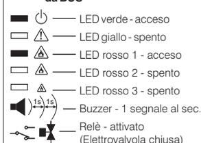
Negli impianti con più apparecchi collegati tramite BUS ad una unità principale, le unità periferiche, quando si trovano nello stato operativo di "allarme presenza gas", trasmettono un segnale all'unità principale che si pone in stato di "allarme presenza gas da BUS". Questo stato è segnalato da un solo LED rosso acceso, il LED rosso 1 (fig. 8).
