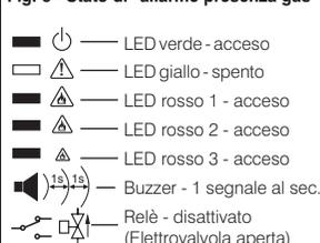
**Fig. 7 - Stato di "allarme presenza gas" e attivazione del relè.**
