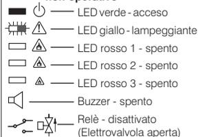
**Fig. 3 - Stato operativo "normale funzionamento"**
