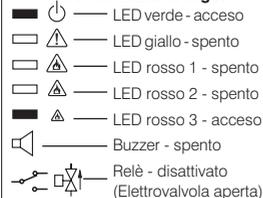
**Fig. 5 - Stato di segnalazione bassa concentrazione di gas**
