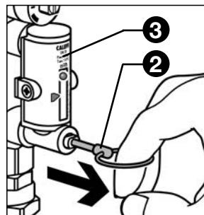
C. Mantendo o obturador aberto, utilizar uma chave de aperto (9 mm) no parafuso de regulação da válvula (4) para efectuar a regulação do caudal. Este é indicado por uma esfera metálica (5), que desliza no interior de um cilindro transparente (6) ao lado do qual é apresentada uma escala graduada de leitura expressa em  $\text{m}^3/\text{h}$ .
