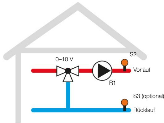
Das Steuergerät steuert das Signal des Raumthermostats (RT). Wenn der Raumthermostat Energie anfordert, werden die Pumpe (R1) und R4 für die Heizanforderung eingeschaltet. Die von Fühler S2 erfasste Temperatur wird überwacht. Das Mischventil wird so gesteuert, dass die eingestellte Temperatur **T Set** gehalten und an S2 erreicht wird.
