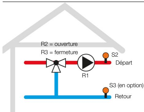
Le régulateur contrôle le signal provenant du thermostat d'ambiance (TA). Lorsque le thermostat d'ambiance demande de l'énergie, la pompe (R1) et R4 sont activées pour assurer un apport de chauffage. La température mesurée par la sonde S2 est monitorée. La vanne mélangeuse est réglée de sorte à atteindre et à maintenir sur S2 la température définie **T Set**.
