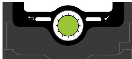
Die Bedienung des Steuergeräts erfolgt über 2 Tasten und 1 Drehschalter (Lightwheel®) unterhalb des Displays:
