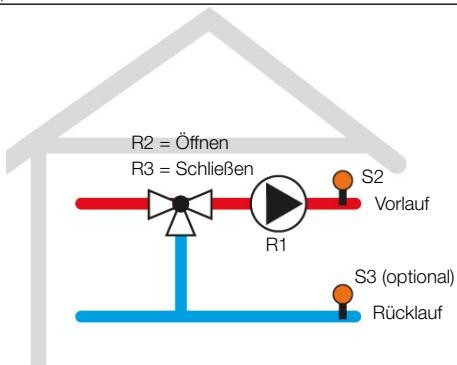
Das Steuergerät steuert das Signal des Raumthermostats (RT). Wenn der Raumthermostat Energie anfordert, werden die Pumpe (R1) und R4 für die Heizanforderung eingeschaltet. Die von Fühler S2 erfasste Temperatur wird überwacht. Das Mischventil wird so gesteuert, dass die eingestellte Temperatur **T Set** gehalten und an S2 erreicht wird.
