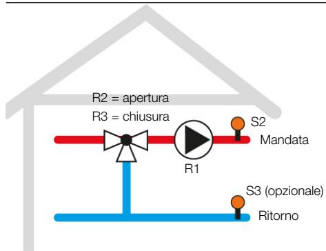
La centralina controlla il segnale dal termostato ambiente (TA). Se il termostato ambiente richiede energia, la pompa (R1) e R4 vengono accese per la richiesta di riscaldamento. La temperatura rilevata della sonda S2 viene monitorata. La valvola miscelatrice viene regolata in modo tale che la temperatura **T Set** impostata viene tenuta e raggiunta su S2.
