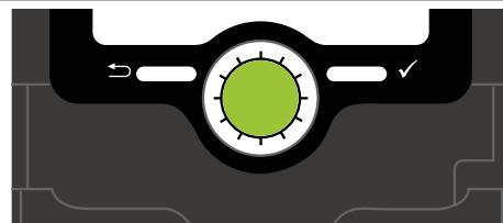
La centralina viene comandata mediante 2 tasti e 1 interruttore rotativo (Lightwheel®) disposti sotto il display:
