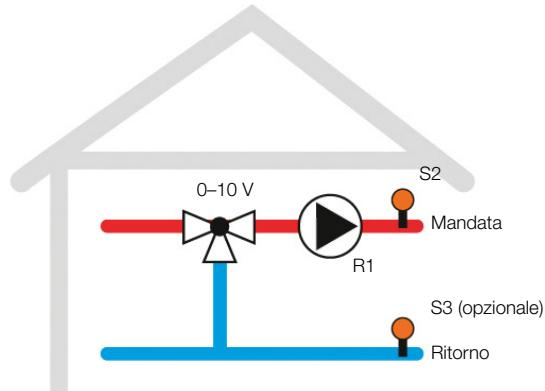
La centralina controlla il segnale dal termostato ambiente (TA). Se il termostato ambiente richiede energia, la pompa (R1) e R4 vengono accese per la richiesta di riscaldamento. La temperatura rilevata della sonda S2 viene monitorata. La valvola miscelatrice viene regolata in modo tale che la temperatura **T Set** impostata viene tenuta e raggiunta su S2.
