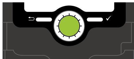
Le régulateur présente 2 touches de commande et 1 interrupteur rotatif (Lightwheel®) sous l'afficheur :
