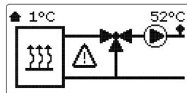
Pressione dell'impianto inferiore al valore minimo **Pmin**.
