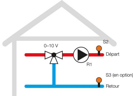
Le régulateur contrôle le signal provenant du thermostat d'ambiance (TA). Lorsque le thermostat d'ambiance demande de l'énergie, la pompe (R1) et R4 sont activées pour assurer un apport de chauffage. La température mesurée par la sonde S2 est monotorée. La vanne mélangeuse est réglée de sorte à atteindre et à maintenir sur S2 la température définie **T Set**.
