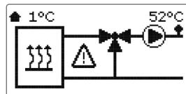
Druk van het systeem lager dan de minimumwaarde **Minimale druk**.
