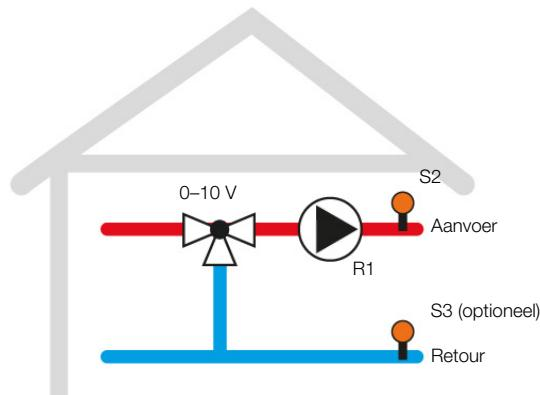
De regeleenheid controleert het signaal van de ruimtethermostaat (OT). Als de ruimtethermostaat energie vraagt, worden de pomp (R1) en R4 ingeschakeld voor het verwarmingsverzoek. De door de sensor S2 gemeten temperatuur wordt bewaakt. Het mengventiel wordt zo geregeld dat de ingestelde temperatuur **T Set** wordt gehandhaafd en bereikt op S2.
