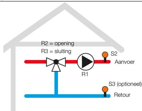
De regeleenheid controleert het signaal van de ruimtethermostaat (OT). Als de ruimtethermostaat energie vraagt, worden de pomp (R1) en R4 ingeschakeld voor het verwarmingsverzoek. De door de sensor S2 gemeten temperatuur wordt bewaakt. Het mengventiel wordt zo geregeld dat de ingestelde temperatuur **T Set** wordt gehandhaafd en bereikt op S2.
