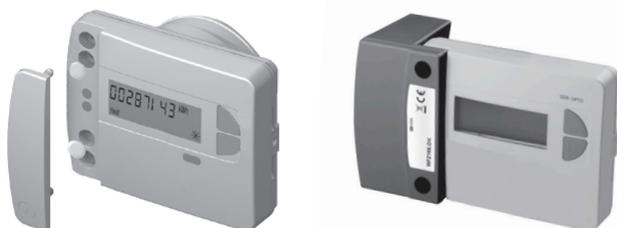
Non appena applicato, il modulo crea una connessione con l'unità di calcolo mediante interfaccia ottica. Se la connessione è corretta, sul display del contatore viene indicato: "FA [versione software]". Dopo 2 minuti vengono acquisiti l'identità e i dati del contatore di calore (gli indirizzi primari rimangono invariati).
